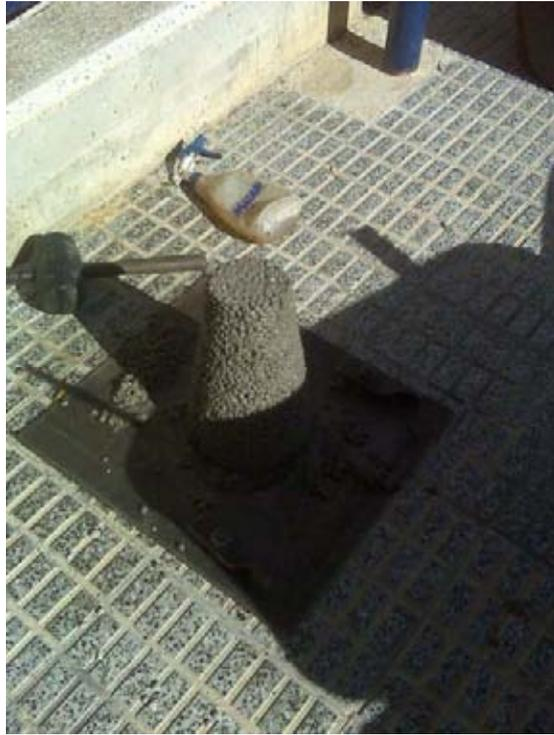
Ensayo de consistencia
