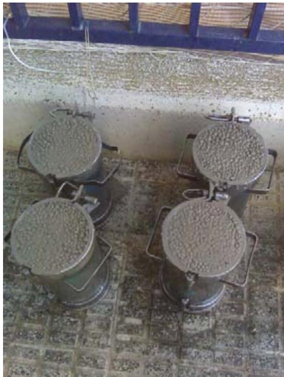
Probetas ejecutadas en obra
