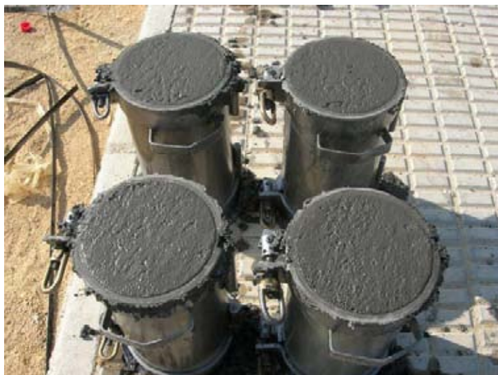
Probetas ejecutadas en obra.
